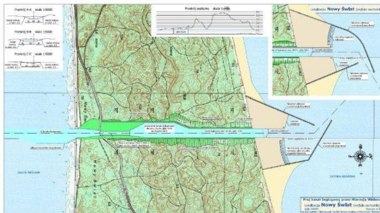
Rys. 3. Koncepcja kanału żeglownego przez Mierzeję Wiślaną – wariant II „Nowy Świat” („Budowa kanału żeglownego przez Mierzeję Wiślaną. Koncepcja techniczna i kosztowa kanału żeglownego wraz z niezbędnymi budowlami hydrotechnicznymi” (2007)
